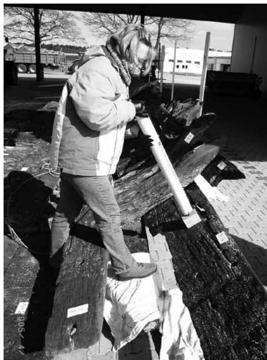
Abb. 5: Bohrwiderstandsmessungen am Wrack im März 2005 (Foto F. Rinn).
