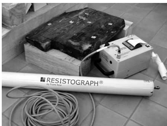
Abb. 3: Der „RESISTOGRAPH“ 3450, bestehend aus Bohrergerät, Akkupack und Verbindungskabel (Foto C. von Laar).
