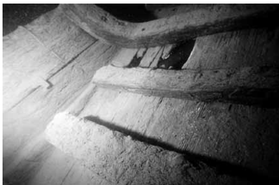
Abb. 8: Untermatt-Wrack, Oberster Plankengang, binnenbords, mit kleinen eisernen Klammern (Foto: © Heidi Hostettler).
