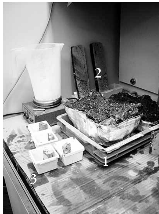
Abb. 1: Eingiessen der Bodenproben. 1 zwei frisch eingegossene Proben, 2 zwei Tranchen (Anschliffe) einer aufgesagten Probe, 3 vier ausgesägte Blöckchen, bereit zur Dünnschliffherstellung (Foto: IPNA/Kristin Ismail-Meyer).
