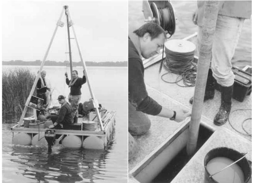
Abb. 2: Bohrplattform (links) und Gefrierkern (rechts), genommen am 8. September 1998 an dem Bohrpunkt ARS 4.
