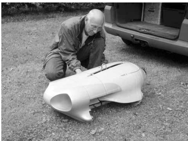
Abb. 3: Ferngesteuertes, unbemanntes Kameratauchboot (ROV) wird von K. Storch vor dem Einsatz zusammengesetzt.
